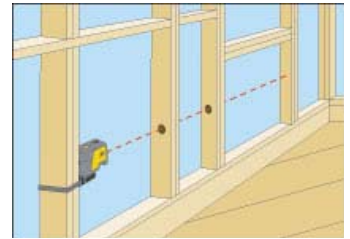
Justering av regler i höjd och sida.
